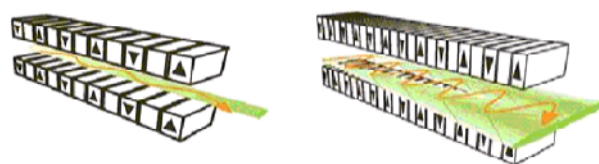
Obr. 2. Vľavo undulátor, vpravo wigler
